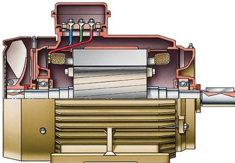
Figure 8 – Moteur électrique
